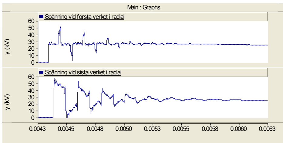
Figur 7. Fasspänning vid första och sista verk i en radial vid tillslag av en vakuumbrytare vid simulering av Kriegers flak.
