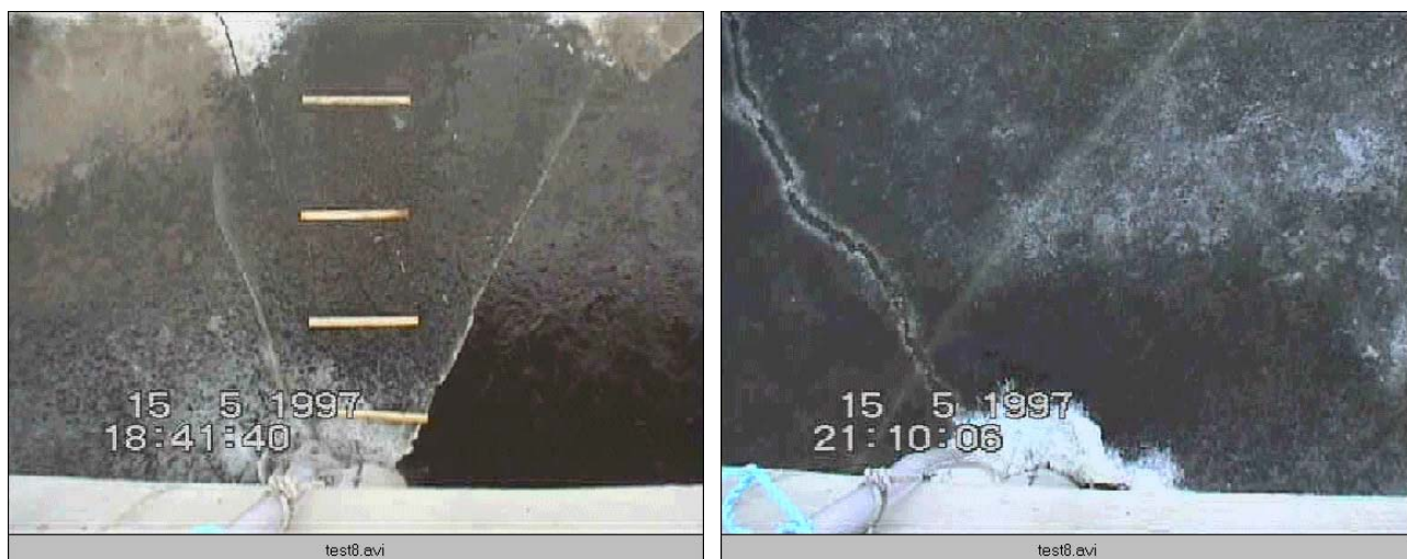
Figur 7 Exempel på isbrytning mot bropelare i Kalix älv i maj 1997 Foto Lennart Fransson Luleå tekniska universitet.
